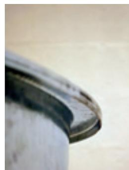
Assemblage des fonds par soudure semi-automatique apportant une étanchéité parfaite.
